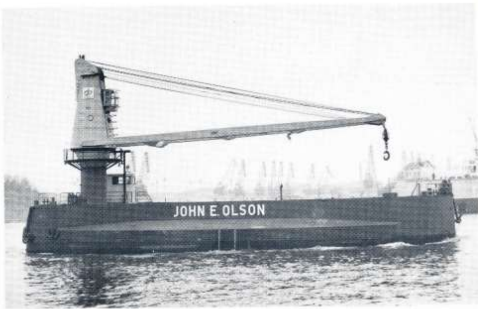
JOHN E OLSON efter ombyggnad till pontonkran för containers. Foto Krister Bång den 22 mars 1972.
